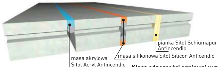
Klasa odporności ogniowej w zależności od zastosowanego materiału do EI240
